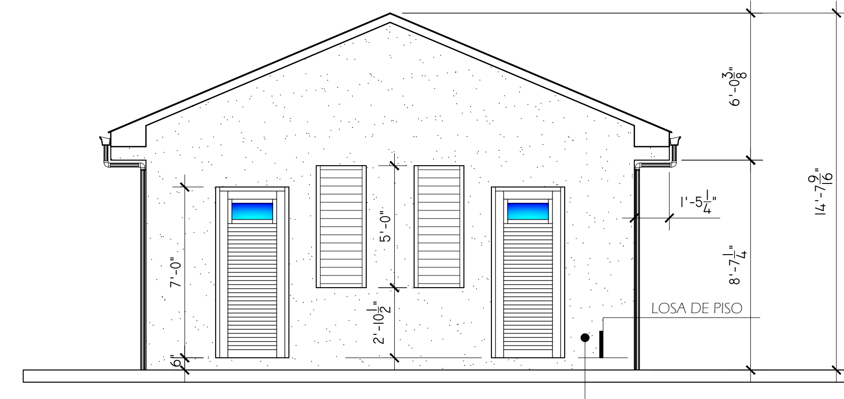
ELEVACION FRONTAL CASETA #4: F ESCALA: 1/4" = 1'-0"
