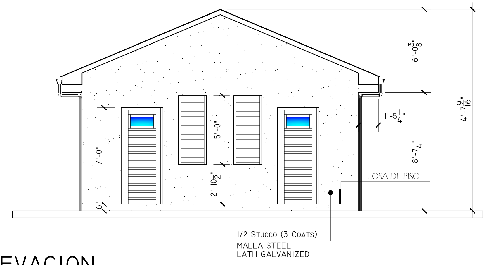
ELEVACION FRONTALCASETA #10: O ESCALA: 1/4" = 1'-0"
